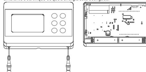
Conforme mostrado na figura acima, pressione a chave de fendas para a frente a partir do espaço mostrado, dobre as tampas e separe a tampa frontal. Insira 2 pilhas alcalinas AAA novas no compartimento da bateria com a posição correta. Substitua ambas as baterias ao mesmo tempo. Em seguida, alinhe a parte frontal do termostato ambiente com a parte de trás e aperte-a para trás.
