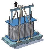
Coloque o permutador de calor de placas sobre os barrotes de madeira.
