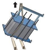
Baixe o permutador de calor de placas para uma posição horizontal e coloque-o no chão.
