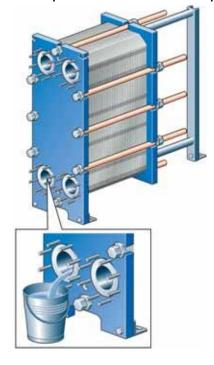
Inspeccione as superfícies de deslizamento da barra de suporte, limpe-as e lubrifique-as.
