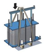
Coloque as cintas em volta de um parafuso, de cada um dos lados.
